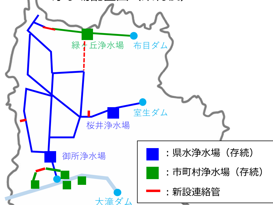
浄水場配置図（集約後）
