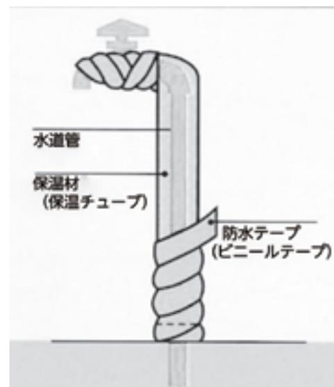
寒い日が続く、明け方の気温が氷点下まで下がると蛇口や水道管が凍ったり、破裂したりします。特に、屋外でむき出しになっているところや日陰で風あたりの強いところなどは凍結しやすいため、むき出しになっている水道管に保温材（布きれ、毛布など）を巻き濡れないように上からビニールテープをすき間なく巻いて保温してください。
