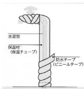
寒い日が続く、明け方の気温が氷点下まで下がると蛇口や水道管が凍ったり、破裂したりします。特に、屋外でむき出しになっている
