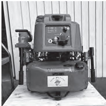
▲ 配備される可搬式消防ポンプ
