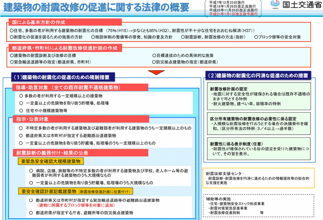
図 1-1 耐震改修促進法の概要
